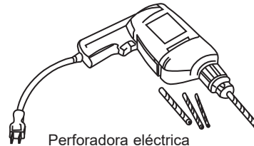
Perforadora eléctrica con mechas de 1/8" y 3/8"
